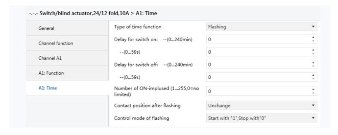
Fig. 4.7 parameter window "X<sub>1,2</sub>: Time-flashing"
