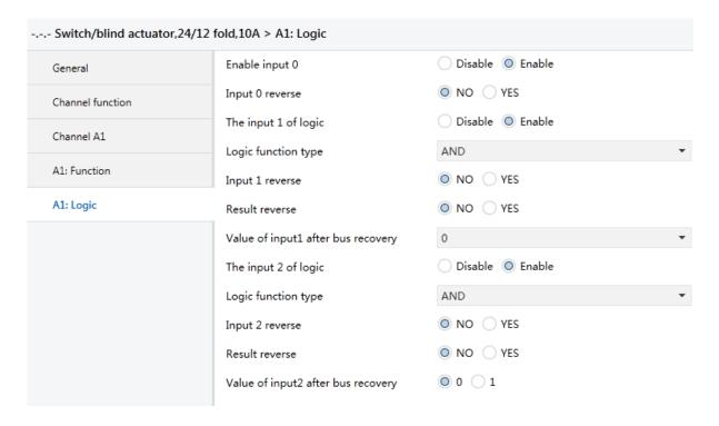
Fig. 4.9 parameter window "X<sub>1,2</sub>: Logic"
