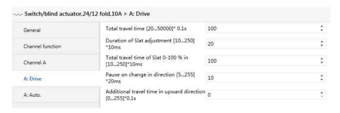
Fig. 4.14 parameter window "X: Drive"
