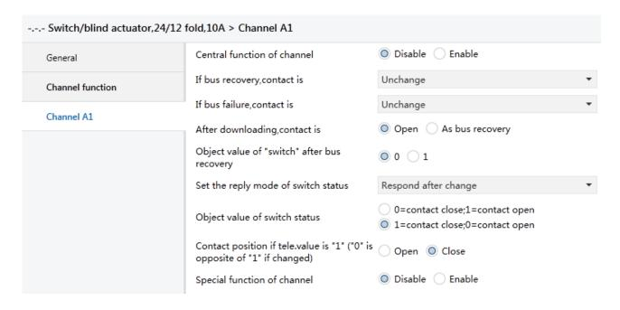
Fig. 4.3 parameter window "Channel  $X_{1,2}$ "
